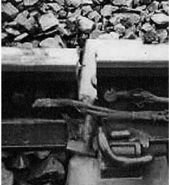
(写真上) 09年3月、京葉線の葛西臨海公園(新木場)間で開けた約30cmのレール破断。(下) JR江差線レールの破断。溶接不足か、発見遅れれば脱線も(09年3月)
